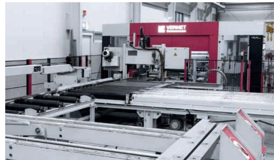
Ligne de sciage et de perçage pour la construction métallique et le commerce de l'acier
